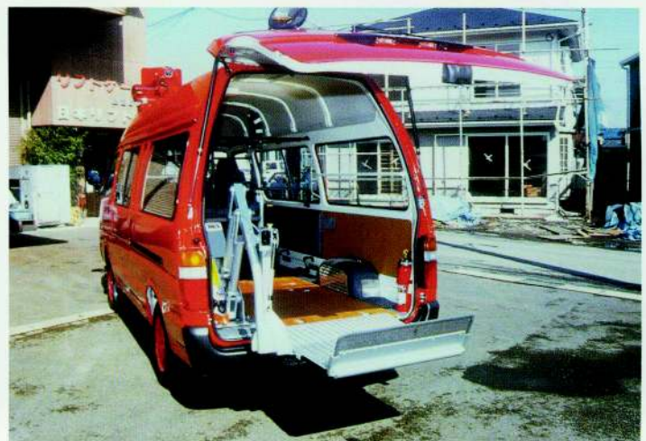
機材運搬用リフト
