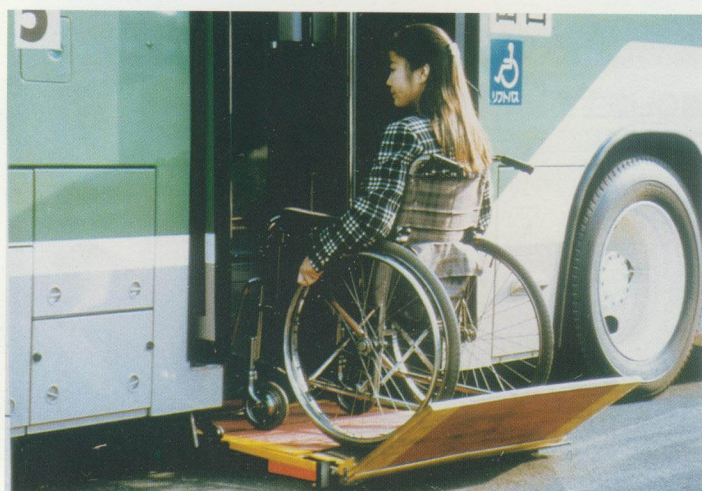
車止め上がり リフトが車輻の床面まで上昇する
